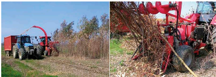
Figura 66 – Esempio di cantiere con taglio-cippatura-carico contemporanei, particolare del taglio a destra.
