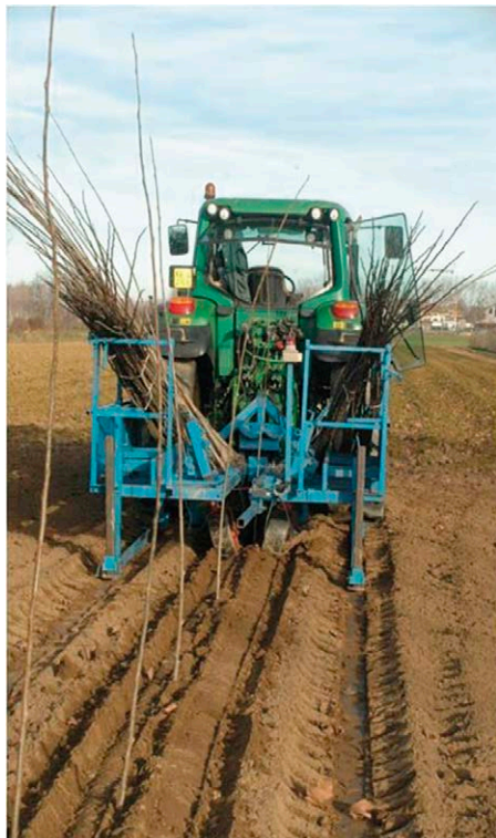
Figura 54 – Macchina per la messa a dimora degli astoni in senso verticale.
