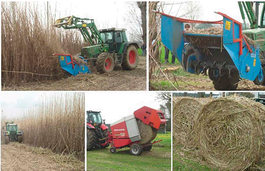
Figura 9 – Cantiere di trincia-andanatura e rotoimbballatura di canna comune.
